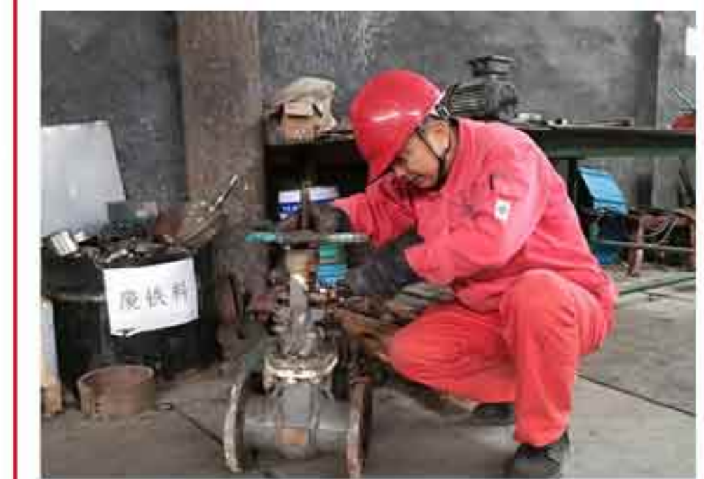
（图为机修班长李玉成对阀门进行更换盘根、填料）
